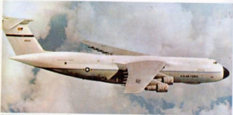
ВОЕННО-ТРАНСПОРТНЫЙ САМОЛЕТ С-5А «ГЛЭКСИ» — основное средство для быстрой переброски тяжелого вооружения на заокеанские ТВД. Дальность полета с максимальной нагрузкой 100 т более 6000 км.
