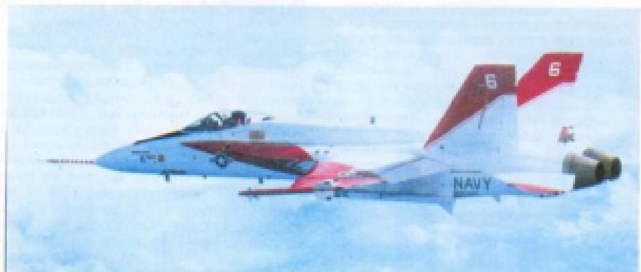
**САМОЛЕТ F/A-18 «ХОРНЕТ».** Для вооружения авианосной авиации и авиации морской пехоты в США разработан многоцелевой сверхзвуковой самолет в вариантах истребителя (F-18) и штурмовика (A-18). Носитель ядерного оружия. Радиус действия F-18 740 км, A-18 — 1020 км. Боевая нагрузка штурмовика A-18 (управляемые ракеты и шквомины) 6080 кг. Общая программа поставок — 1377 самолетов F/A-18. Стоимость одного самолета — 42,3 млн. долл.
