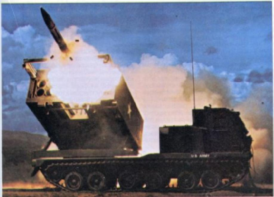
РЕАКТИВНАЯ СИСТЕМА ЗАЛПОВОГО ОГНЯ MLRS. Предназначена для стрельбы на дальность до 40 км неуправляемыми ракетами с кассетными боевыми частями, в том числе снаряженными бинарными отравляющими веществами.
