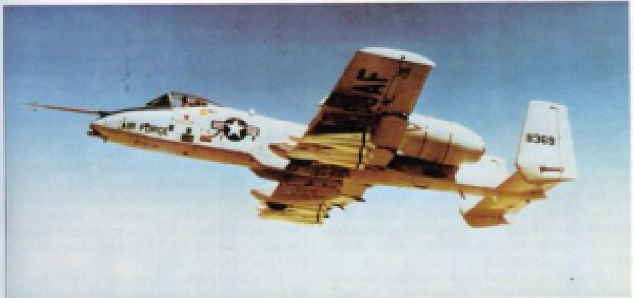
ШТУРМОВИК А-10 «ТАНДЕРБОЛТ». Радиус действия 460—1000 км. Максимальная боевая нагрузка (управляемые и неуправляемые ракеты, авиабомбы) 7260 кг. Поступил на вооружение ВВС США в 1974 г.
