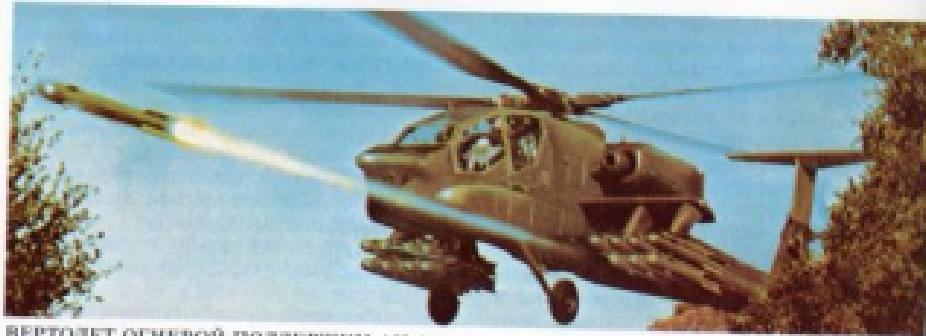
**ВЕРТОЛЕТ ОГНЕВОЙ ПОДДЕРЖКИ АН-64А.** Для наращивания огневой мощи сухопутных войск в США создан вертолет АН-64А, вооруженный 16 противотанковыми управляемыми ракетами «Хедлайпер» (с лазерной головкой самонаведения) и 30-мм пушкой. Общая программа поставок до 1989 г. — 536 вертолетов на сумму около 6 млрд. долл.
