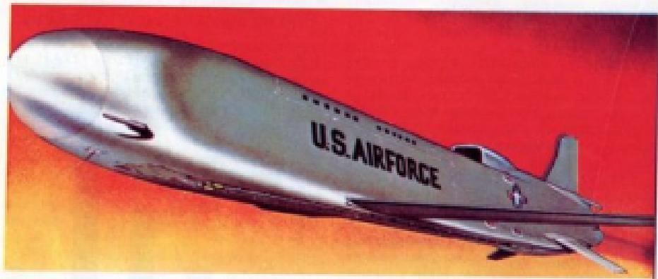
СТРАТЕГИЧЕСКАЯ КРЫЛАТАЯ РАКЕТА ВОЗДУШНОГО БАЗИРОВАНИЯ АЛСМ-В. Предназначена для нанесения высокоточных ядерных ударов по объектам практически на всю глубину территории СССР. Дальность стрельбы 2600 км. Оснащена ядерной боевой частью мощностью 200 кт. В 1981 г. поступила на вооружение бомбардировщиков B-52. Такими ракетами будут оснащаться также новые стратегические бомбардировщики B-1B.
